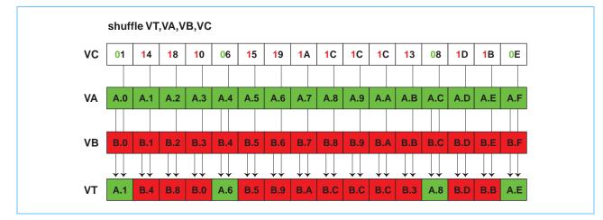
Figure 1-6. Byte-Shuffle Operation
